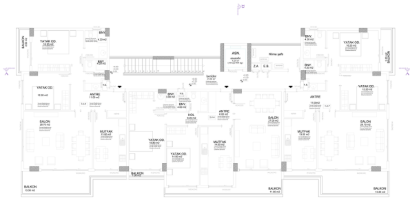
NORMAL KAT PLANI ( 0.00,+3.30,+6.60KOTU ) ÖLÇEK : 1 / 50
