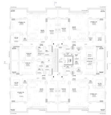
NORMAL KAT PLANI (+7.12,+10.42,+13.72KOTU) ÖLÇEK : 1 / 50
