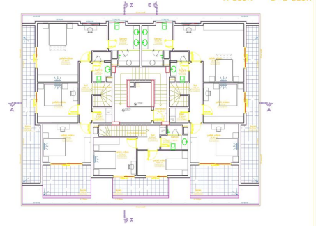
A-D-E BLOK ÇATI ARASI PLANI (+14.70 KOTU)
